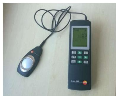
Slika 3-42 Luksmetar za mjerjenje osvjetljenosti
