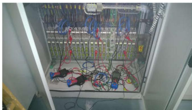
Slika 3-41 Mjerena električnih veličina strujnim klještima
