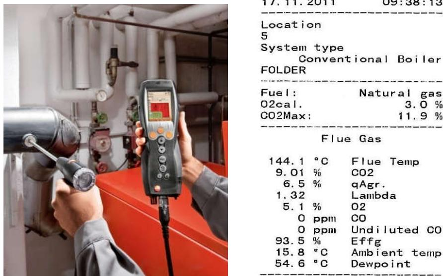
Slika 3-47 Mjerenje sastava dimnih plinova na izlazu iz kotla uređajem za mjerenje sastava dimnih plinova
